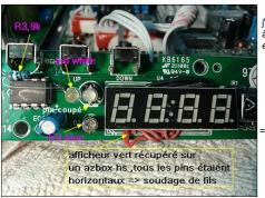
j'ai coupé la patte + de la led double (rouge/orange) et raccordé ma led blanche (+) ;le - est soudé avec une résistance de 3.9k à la masse ...,mon afficheur vert a été récupéré sur un azbox hs (même shéma de banchement) seulement tous ses pins étaient en position horizontale, j'ai du de ce fait raccorder des fils de branchement vers la carte
